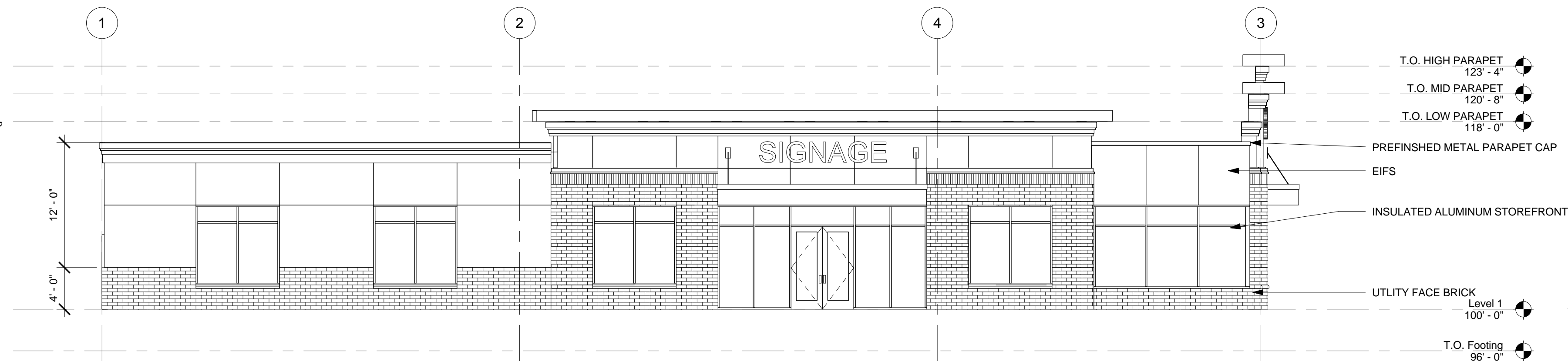
A4 WEST EXTERIOR ELEVATION 1/8" = 1'-0"
